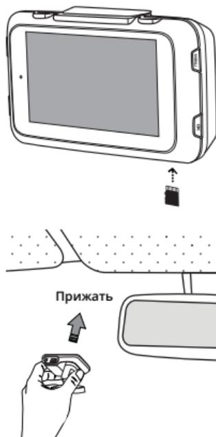
5. Отрегулируйте положение устройства для оптимального обзора и закрепите его с помощью фиксатора кронштейна ④.
