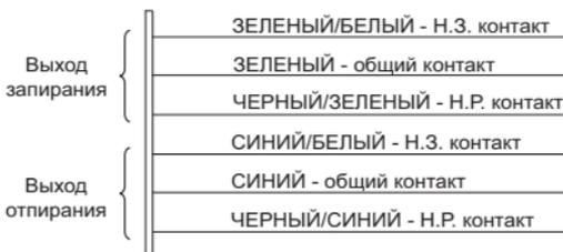
Перед подключением системы к установленным электроприводам замков дверей необходимо определить тип штатной системы центрального замка. Для этого – выньте выключатель дверного замка из панели двери водителя и протестируйте провода, идущие от выключателя.
